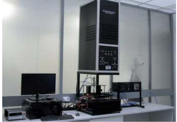
Symulator słoneczny umożliwiający pomiary pojedynczego ogniwa
