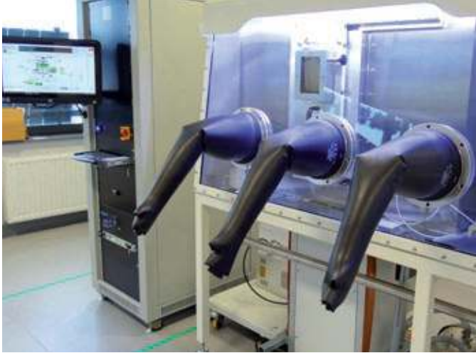
System do depozycji cienkich warstw z komorą rękawicową
