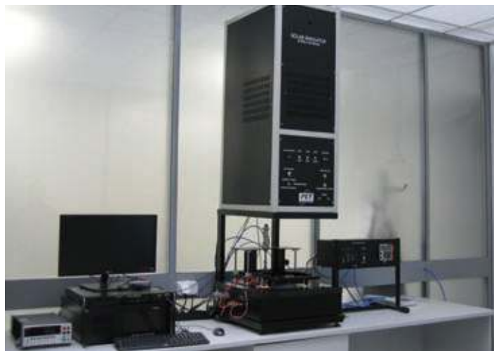
Symulator słoneczny umożliwiający pomiary pojedynczego ogniwa
