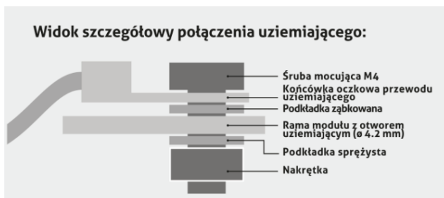
Rysunek 8: Widok szczegółowy połączenia uziemiającego.
