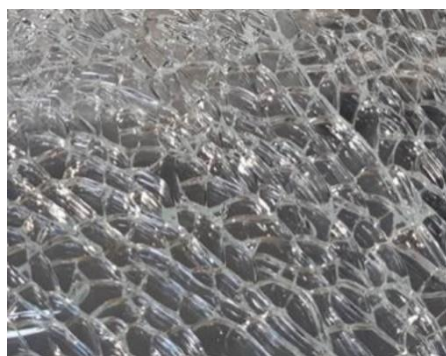
Rys. 16. Siatka spękań szkła hartowanego
